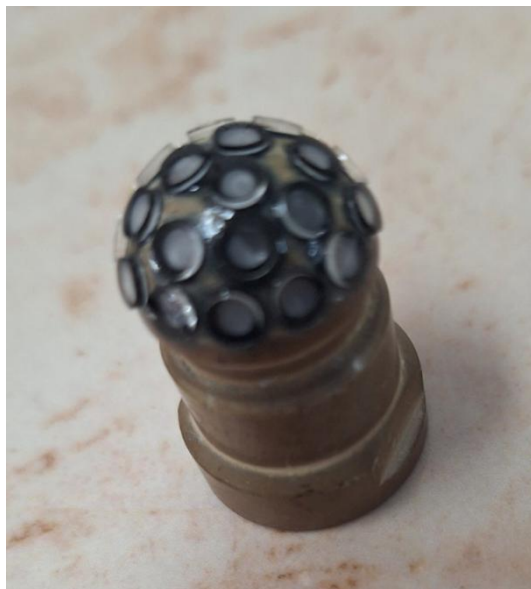
Фигура 133. Конзола за групово полиране на оптични детайли.
