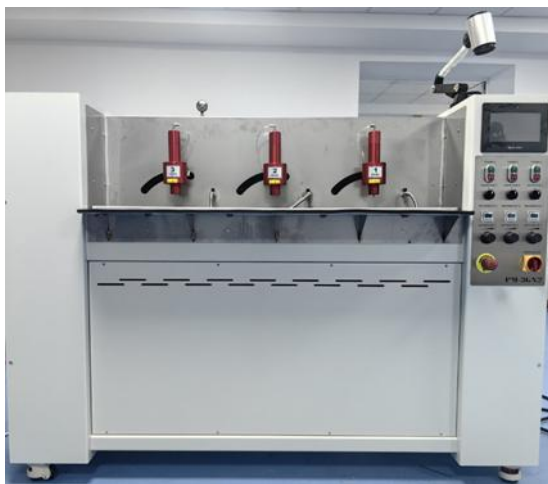
Фигура 1. Полираща машина тип PM-3GN2.
