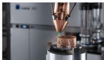
НАВАРЯВАНЕ ПОСРЕДСТВОМ ЗЕЛЕНО ЛАЗЕРНО ЛЪЧЕНИЕ
