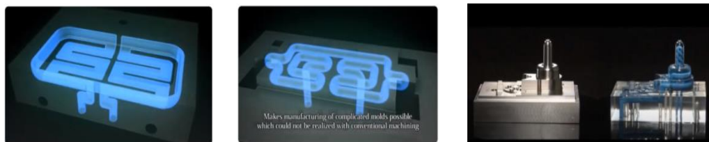
Фигура 5. Охлаждаща система на шприцформа [5]
