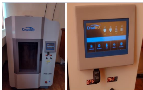
Фигура 2. Принтер Creat Bot PEEK – 300 LCD панел
