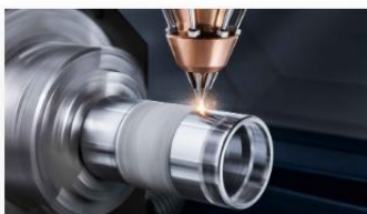
ВИСОКОСКОРОСТНО НАВАРЯВАНЕ (HS-LMD)
