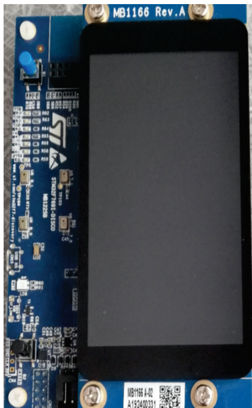
Фиг. 1. Вградена мобилна система STM32F769IDISCOVERY
