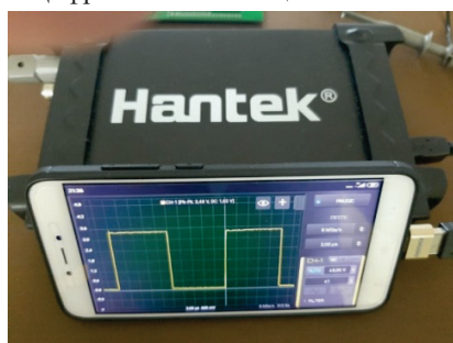
Фиг. 5 Hantek 6022BE, свързан към мобилен телефон
