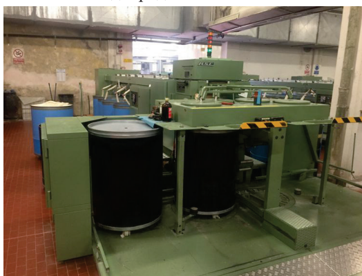
Фиг. 2. Машина за разресване - „дарак“
