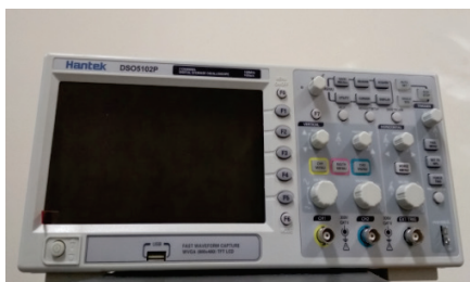
Фиг. 2 Цифров осцилоскоп Hantek модел DSO5102P
