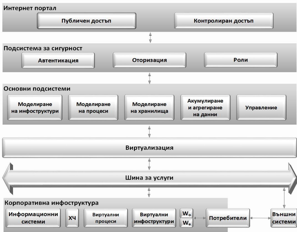
Фигура 1. Архитектура на софтуерна среда за проследяване, анализ и мониторинг на корпоративна ИКТ инфраструктура
