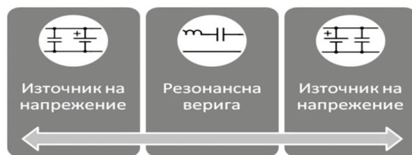
Фиг. 1 Блокова схема на последователно резонансен реверсивен DC-DC преобразувател
