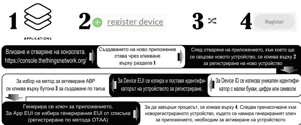
Фиг.3. Регистриране на краен възел в TTN (The Things Network Console, 2019)
