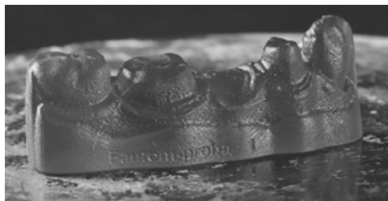
Фигура 5 Основа изработена чрез метода на триизмерно принтиране.
