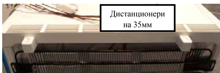
Фиг. 2. Монтаж на дистанционери
