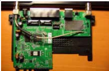
Фиг. 1 Изглед от вътре на рутера WRT54G
