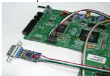
Фиг. 3 RS-232 драйверен модул, свързан към рутера
