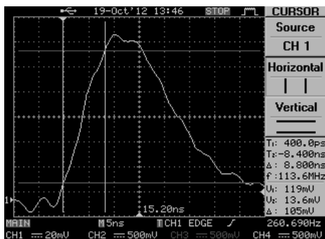
Фиг.4. Време на нарастване на предния фронт на изходния светлинен импулс от светодиод LXX2-PR14-Q00.
