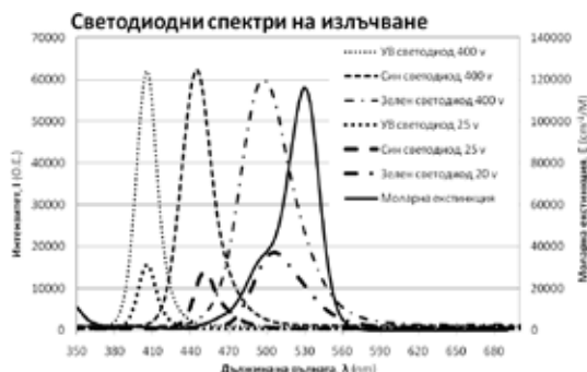
Фиг.7. Спектри на излъчване на ултравиолетов, син и зелен светодиод и спектър на поглъщане на Р6Ж.
