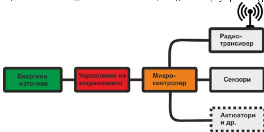
Фиг. 1. Обобщен модел на мрежово свързано смарт устройство
